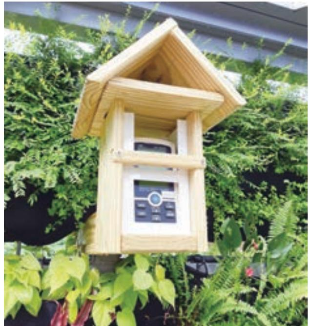
監測試驗之感應器，以木製鳥屋方式呈現，兼具保護儀器及生態融合意象
