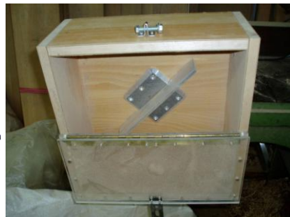
圖 1-1 (a) 顆粒堅牢度測試設備 (ASAE S269.4)
